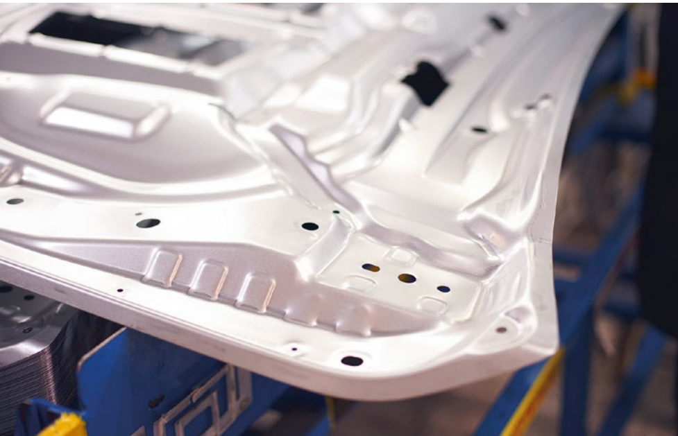
BILD 3 Superplastic-Forming bietet Herstellern die Möglichkeit, Bauteile mit geringen Wandstärken kostengünstig herzustellen. (© AdobeStock@narachal)
