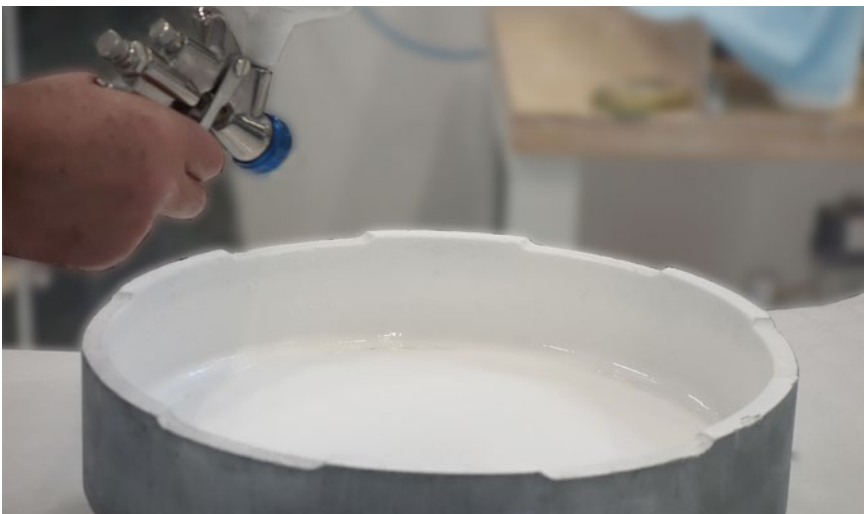
BILD 5 Das Bornitrid-Coating lässt sich einfach aufsprühen. (© Henze BNP)
