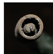
Nach Gebrauch: HeBoCoat® SL-E 125 verhindert das Zusetzen der Schweißdüse und ein Blockieren des Schweißdrahtes.
