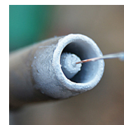
Schweißdüse mit HeBoCoat® SL-E 125 Beschichtung.
