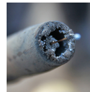
Schweißdüse ohne HeBoCoat® SL-E 125 Beschichtung.
